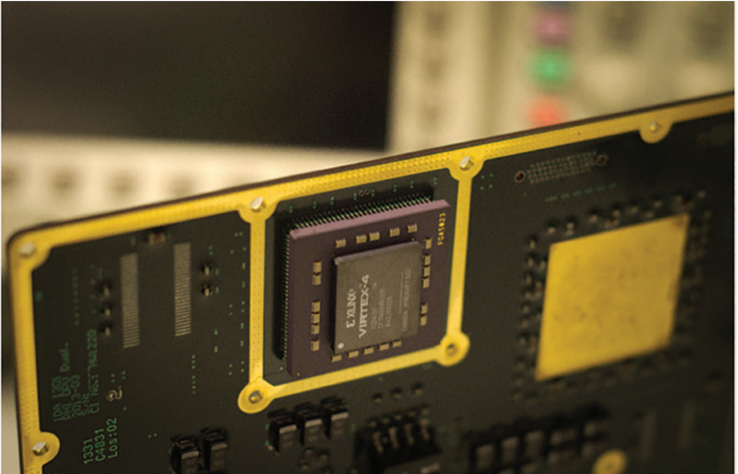
図 3 - はんだ付けされたデジタイズ チェーン デバイスを搭載した検証用ボード
